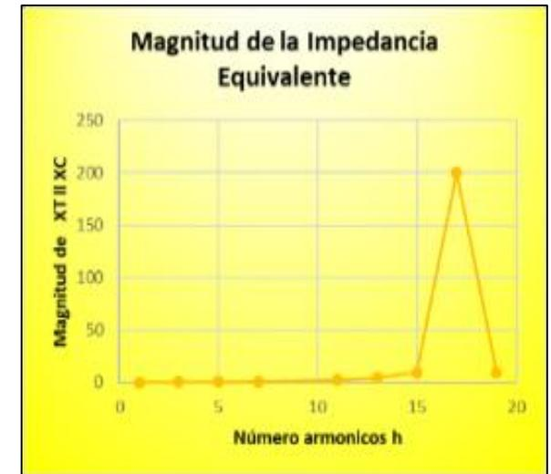
Fig. 2 Escenario de una resonancia en paralelo
